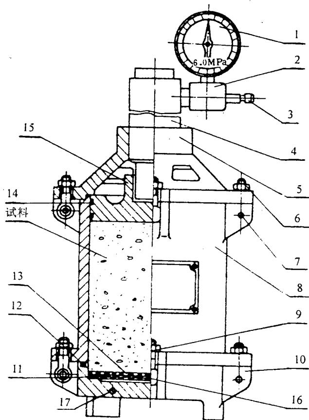
1—压力表；2—三通；3—（接手动油泵）输油管接头；4—油缸；5—上盖；
