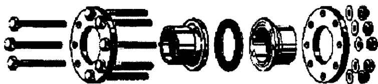
图4 法兰连接
