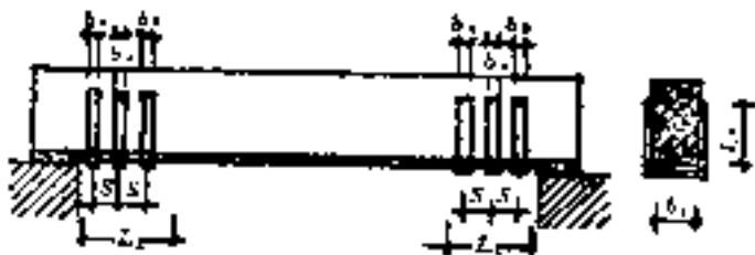
附图 1.2 梁端增设 U 型箍板锚固
